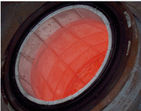
1 2 \ Precast shapes lining Revestimiento en piezas
